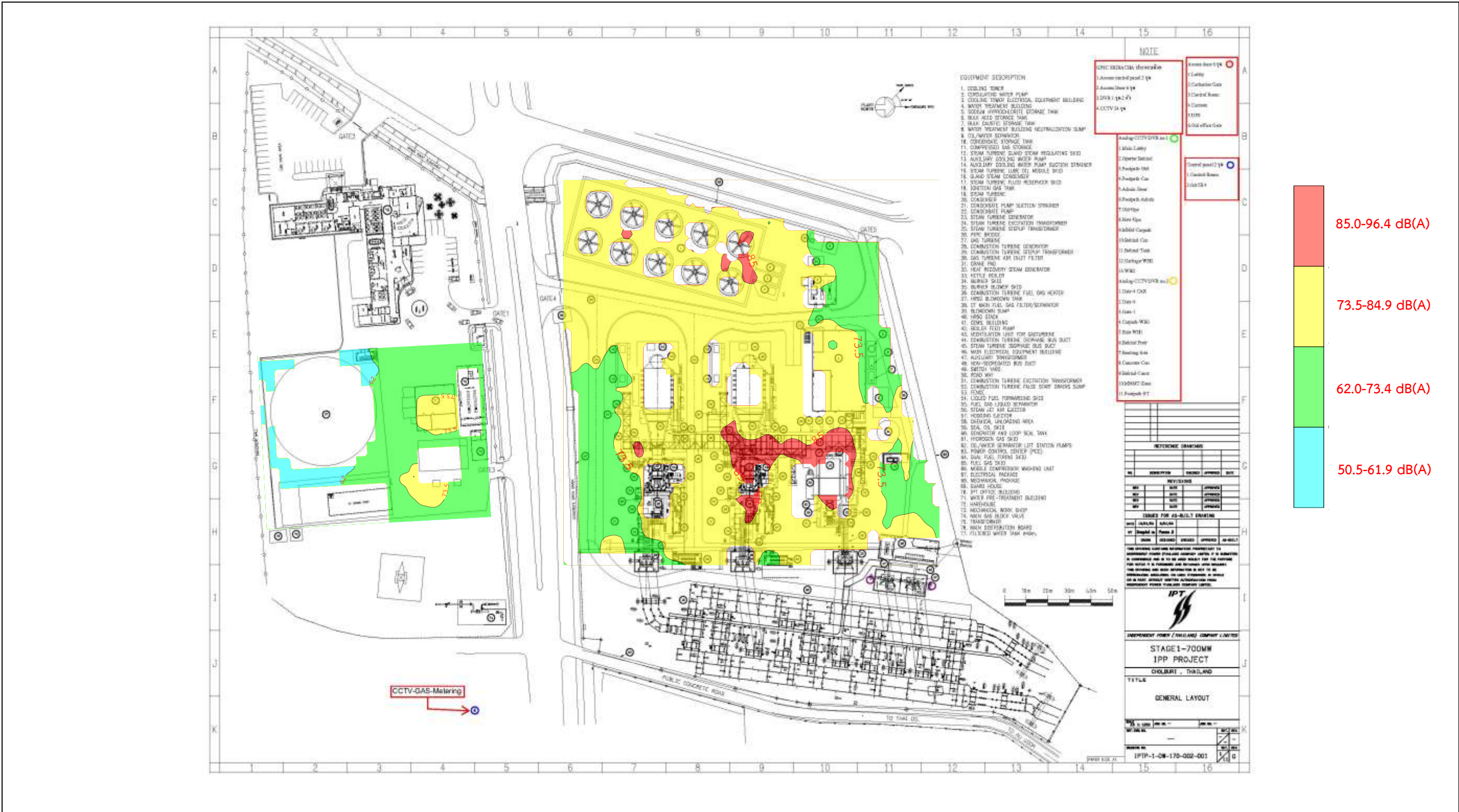
รูปที่ 6 ผลการติดตามตรวจสอบแผนที่เส้นระดับเสียง (Noise Contour Map) บริเวณพื้นที่โครงการ เมื่อวันที่ 30 เมษายน พ.ศ. 2567 บริษัท โกลบอล เพาเวอร์ ซินเนอร์ยี จำกัด (มหาชน)
